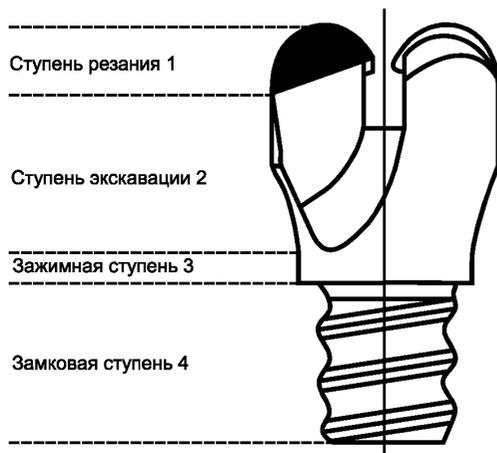
Рисунок 2 — Конструкция бурового резца
