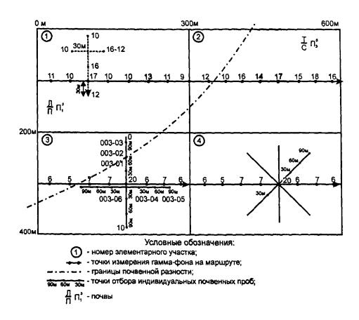
**Рис.**1. Схема дополнительных измерений и отбора индивидуальных почвенных проб при повышенных значениях гамма-фона
