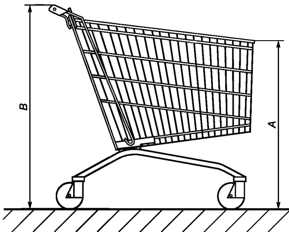
Рисунок В.3 — Измерение размеров A и B
