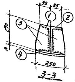
После установки балки БМТ-1 гнездо заделать бетоном м. 200
