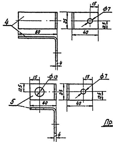
Спецификация на детали заземления (общее количество на ТП)
