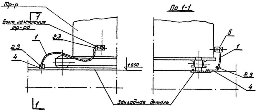
Узел крепления к стене заземляющей полосы М1:2
