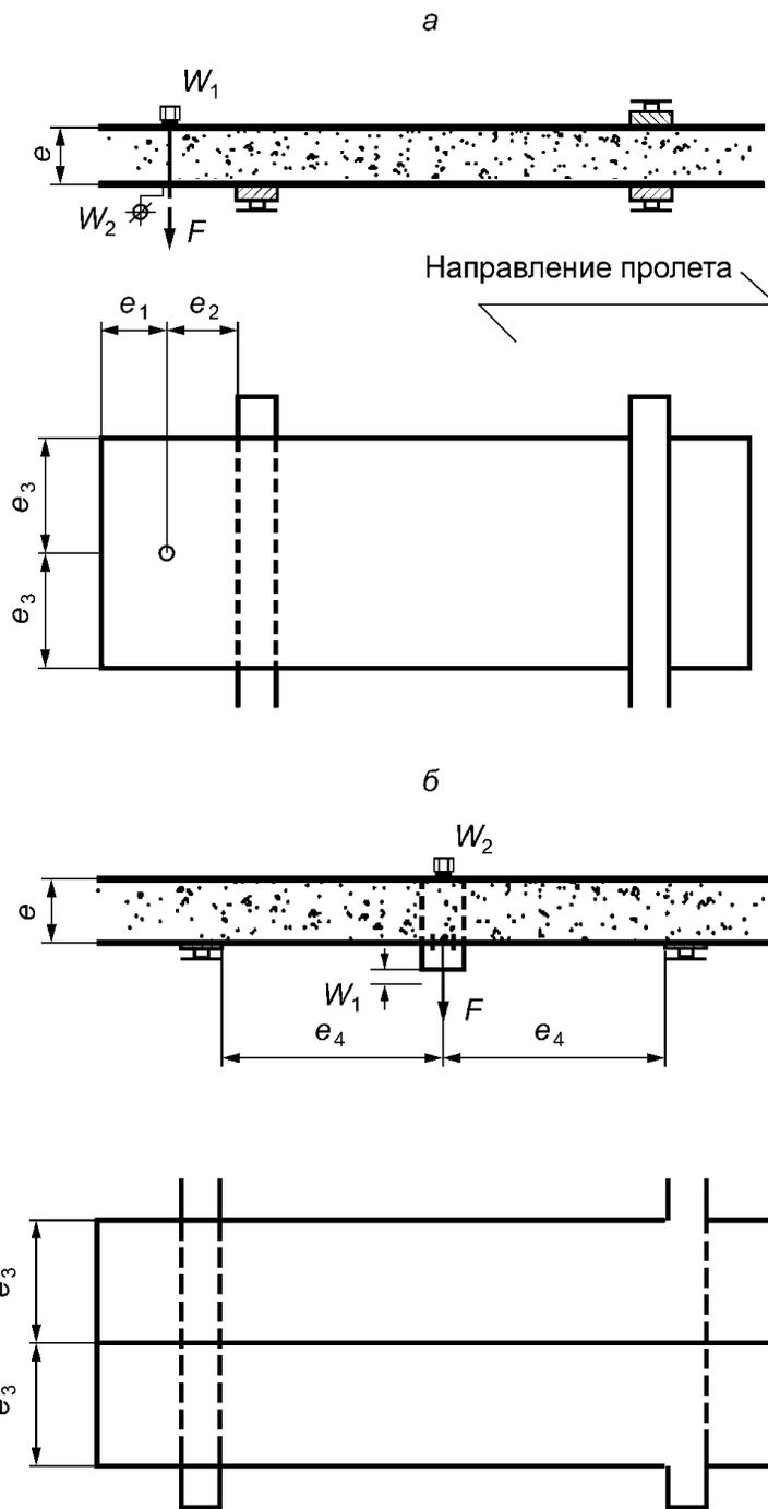
а — крепление на крайней опоре; б — крепление на средней опоре;  $e_1$  — минимальное расстояние от кромки панели;  $e_2 \geq 100$  мм;  $e_3 \geq B/4$ ;  $B$  — ширина панели;  $e_4 \geq 100$  мм
