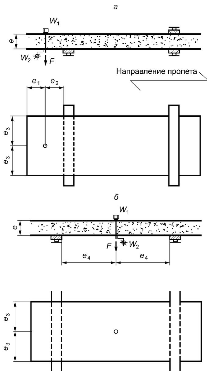
а — крепление на крайней опоре; б — крепление на средней опоре;  $e_1$  — минимальное расстояние от кромки панели;  $e_2 \geq 100$  мм;  $e_3 \geq B/4$ ;  $B$  — ширина панели;  $e_4 \geq 100$  мм
