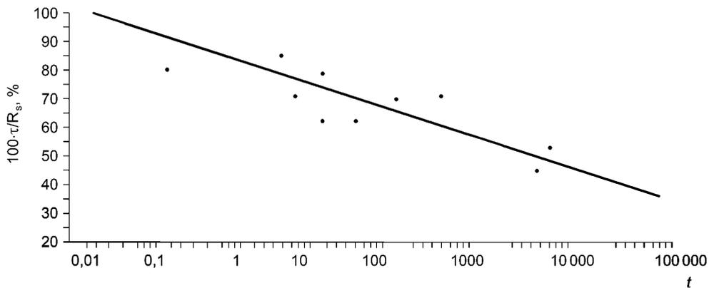
$t$  — время, ч;  $\tau$  — напряжение сдвига в образце;  $R_s$  — прочность на сдвиг (кратковременная)
