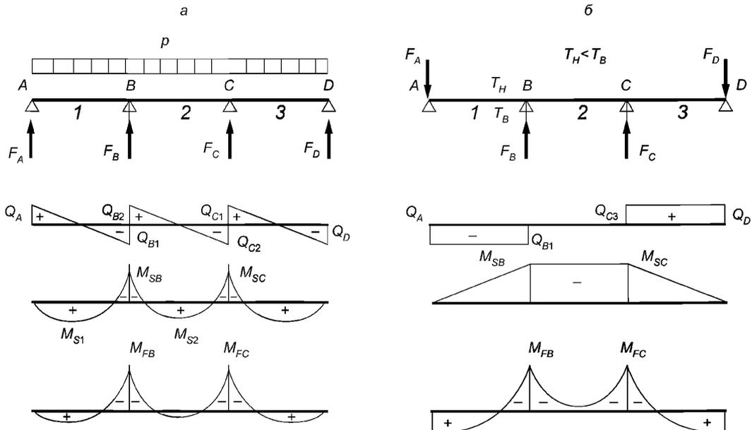
а — усилия в панели от постоянной нагрузки; б — усилия в панели от разности температур на обшивках; 1, 2, 3 — пролеты
