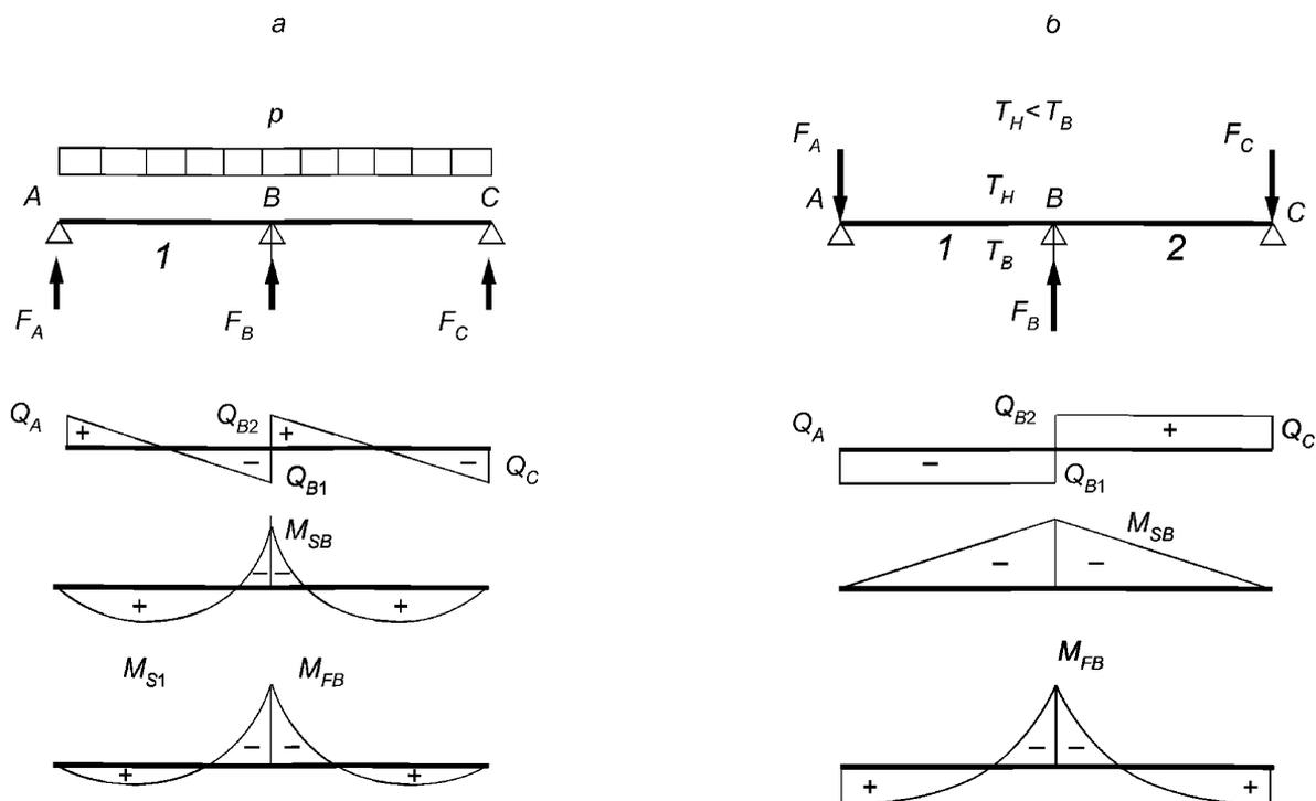
а — усилия в панели от постоянной нагрузки; б — усилия в панели от разности температур на обшивках;
