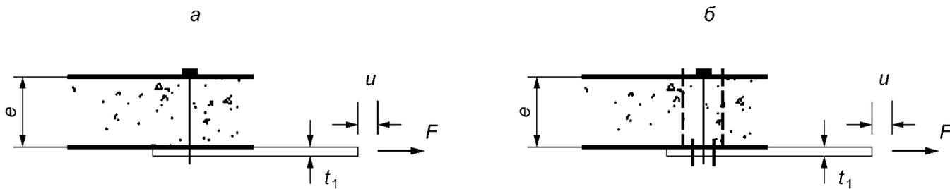
а — крепление винтом; б — специальное крепление панели
