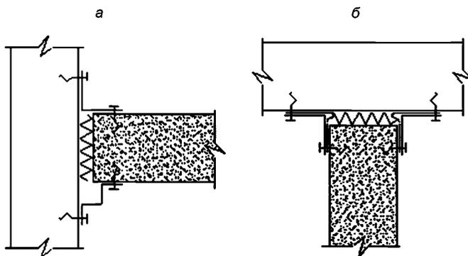
а — потолок — внешняя стена; б — внутренняя стена — потолок (эластичной лентой); в — внутренняя стена — потолок;
