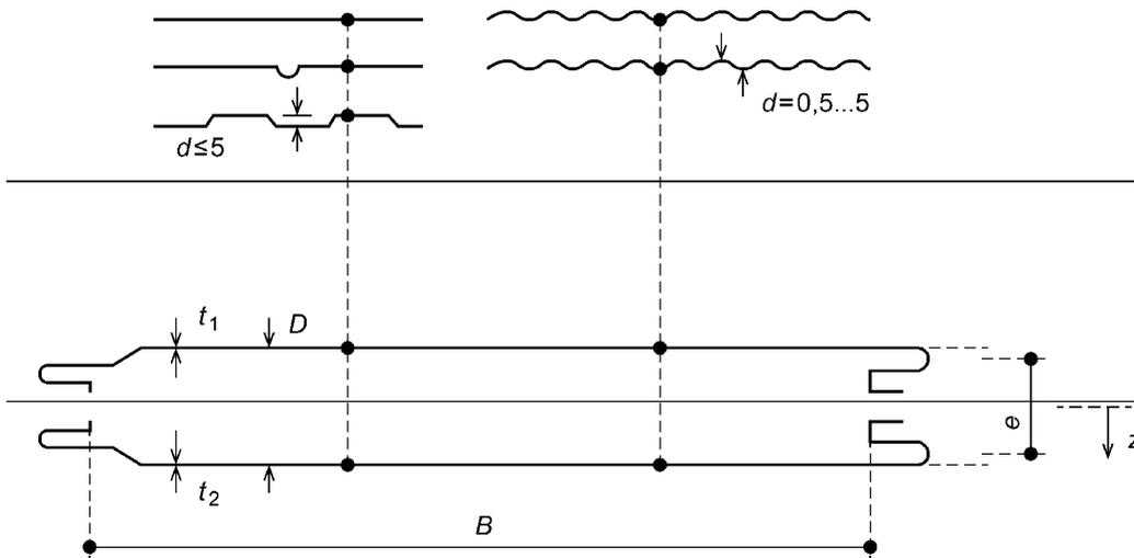
Рисунок 1 — Параметры гладких и слабопрофилированных обшивок
