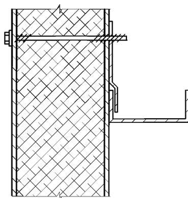
Рисунок 11 — Крепление панели к каркасу в холодильниках
