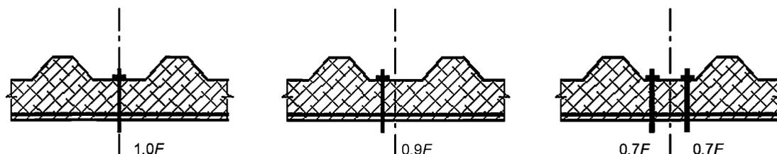
Рисунок 12 — Крепление кровельных панелей самонарезающими винтами
