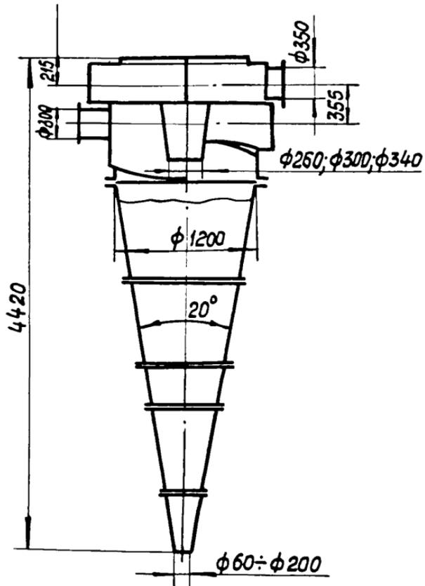
Рис. 2. Гидроциклон  $\phi 1200$  мм.
