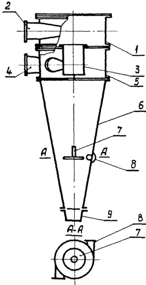
Рис. 6. Гидроциклон-классификатор.
