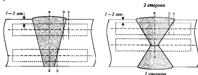
Рис. 6.4.4.4-2 Схема вырезки и расположения надреза на образцах для испытаний на ударный изгиб для технологических процессов сварки с погонной энергией  $\leq 50$  кДж/см:
