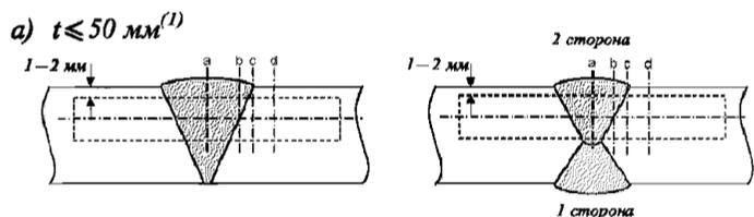
Примечание (1): Для технологии односторонней сварки толщин выше 20 мм требуется испытание дополнительной серии образцов по линии "а" и "б" со стороны корня шва.
