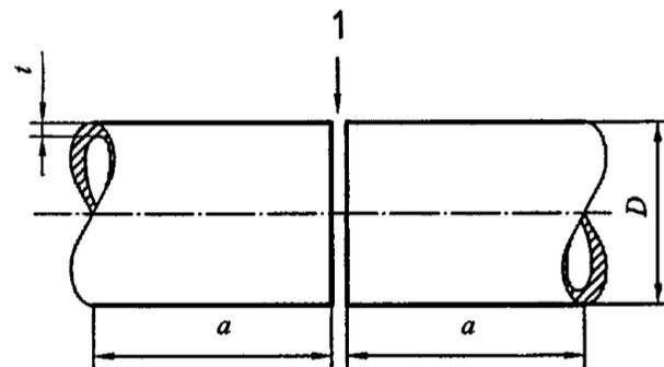
**Рис. 6.3.1.3** Проба стыкового сварного соединения труб:
