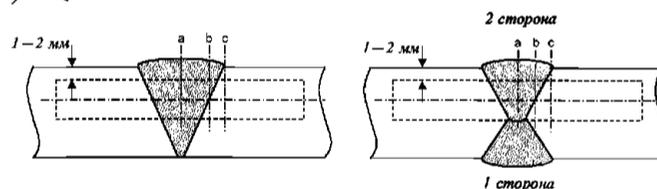
Примечание (1): Для технологии односторонней односторонней сварки толщины выше 20 мм требуется испытание дополнительной серии образцов по линии "а" со стороны корня шва.
