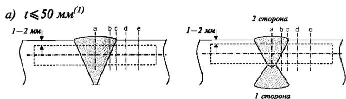
Примечание (1): Для технологии односторонней сварки толщин выше 20 мм требуется испытание дополнительной серии образцов по линии "а", "б" и "с" со стороны корня шва.
