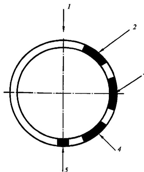
Рис. 8.3.2.1-2 Схема отбора образцов из пробы стыкового соединения труб:
