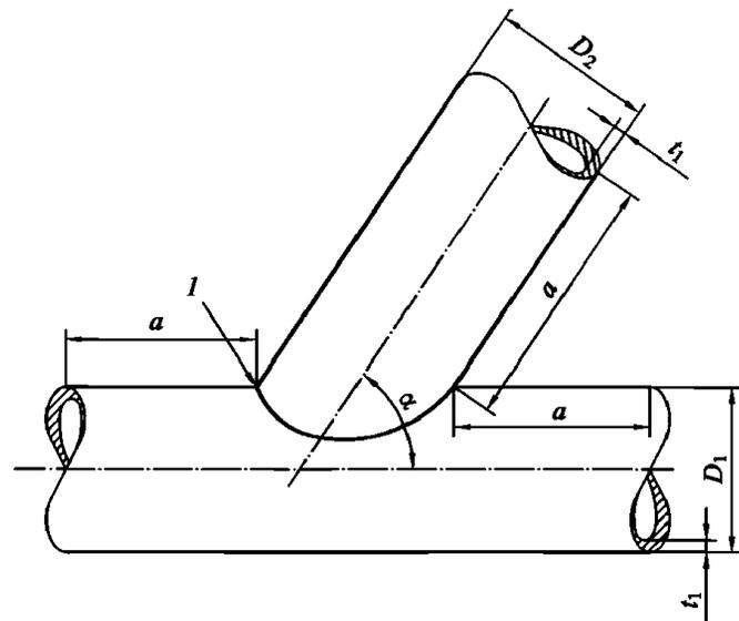
Рис. 8.2.2.7 Проба узла сочленения труб:
