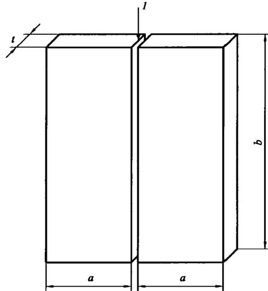
Рис. 8.2.2.4 Проба стыкового соединения листов:
