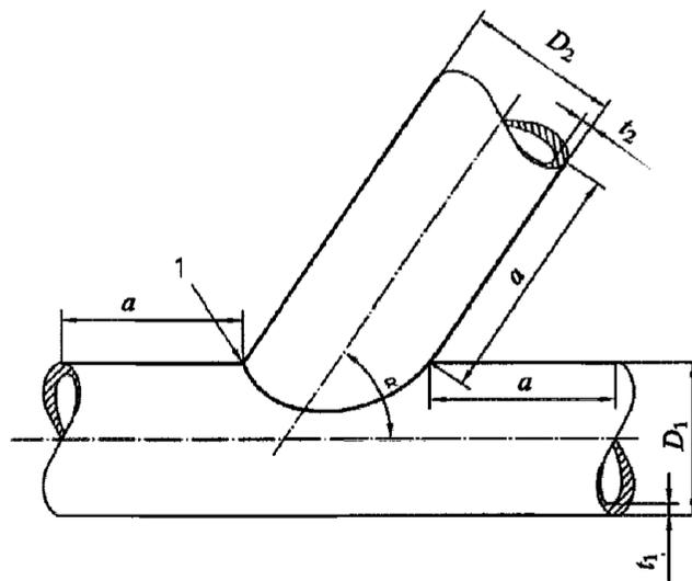
Рис. 6.3.1.6 Проба узла сочленения труб:
