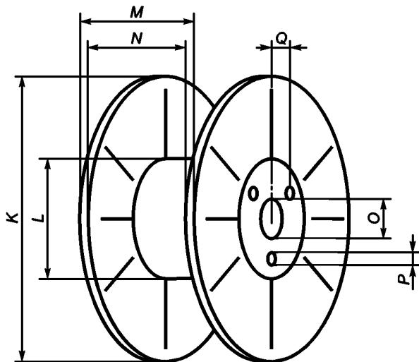
*K* — диаметр фланца; *L* — диаметр цилиндра; *M* — общая ширина катушки; *N* — длина цилиндрической части; *O* — диаметр канала катушки, идущего через всю ширину катушки; *P* — диаметр отверстий, используемых для перемещения катушки, и число таких отверстий; *Q* — расстояние от центра фланца до отверстий, используемых для перемещения катушки
