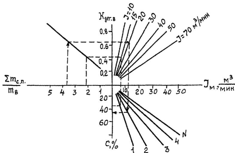
Рис.13.4.1 Номограмма для определения параметров дегазации сближенных пластов и выработанного пространства скважинами с поверхности.
