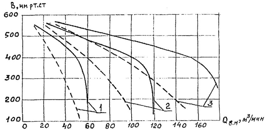
———— типовой аэродинамической характеристике вакуум-насоса
