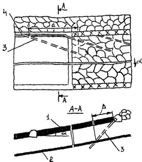
Рис.3.2.1 Схема дегазации надрабатываемого пласта скважинами, пробуренными из вентиляционной выработки, при столбовой системе разработки с погашением выработки за лавой :
