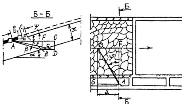
Рис. ПЗ.2.2 Графическое определение параметров дегазационных скважин, буримых на надрабатываемые пласты
