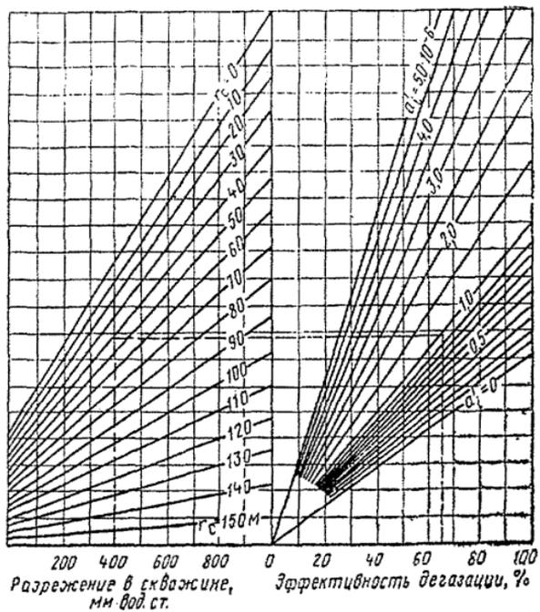
Рис.ПЗ.І.8 Номограмма для определения расстояния между скважинами при их бурении на подрабатываемые угельные пласты
