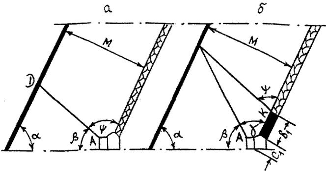
Рис.ПЗ.3.1 Схема к определению направления скважины, буримой из откаточного штрека на вышележащий облегающий пласт в плоскости, нормальной к простиранию пласта:
