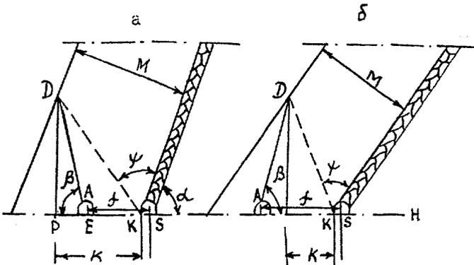
Рис.ПЗ.3.2 Схема к определению направления скважины, буримой из группового откаточного штрека на вышележащий облегающий пласт, в плоскости, нормальной к простиранию пласта, при отсутствии целика угла (бутовой полосы) над штреком:
