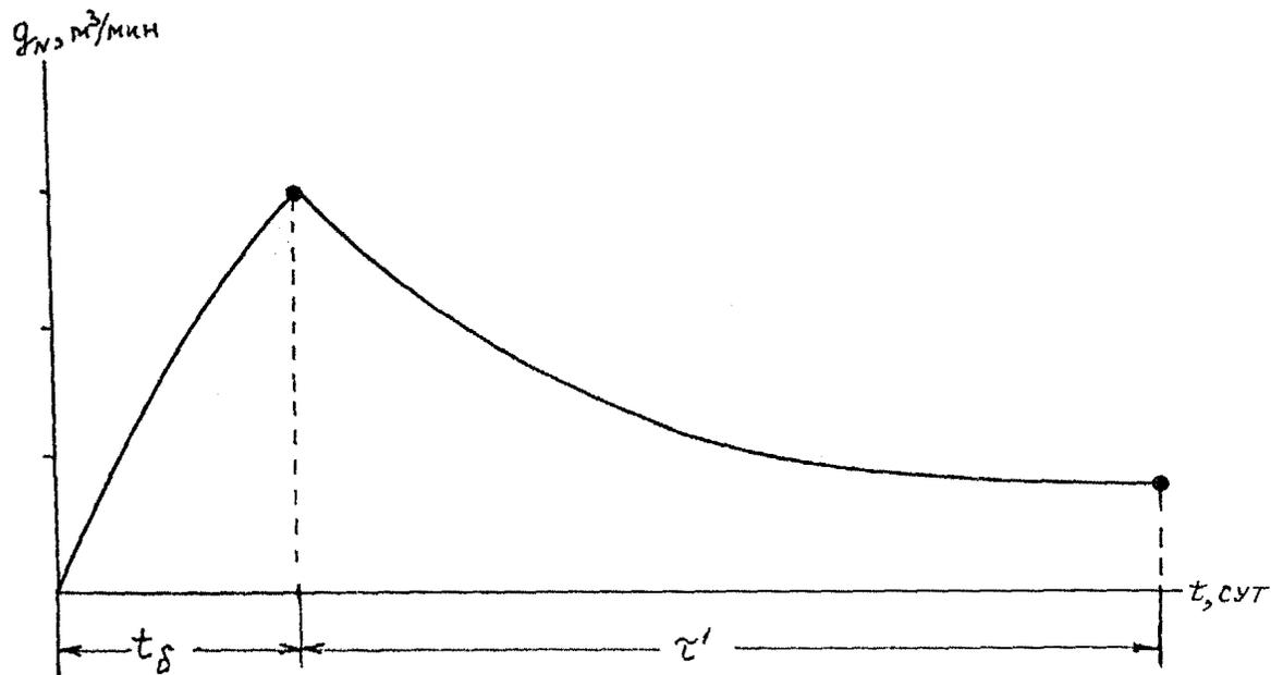
$q_N$  - метановыделение;  $t$  - время;  $t_g$  - время обуривания пласта на вспомочном участке;  $t'$  - продолжительность дегазации пласта группой скважин
