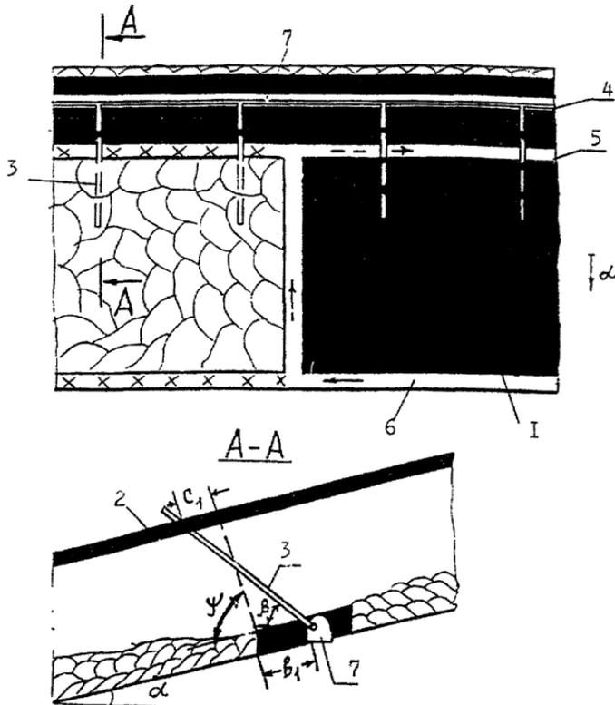
1-разрабатываемый пласт; 2-сближенный пласт; 3-скважина дегазационная; 4-газопровод; 5-вентиляционный штрек; 6-конвейерный штрек; 7-выработка, охраняемая целиком углём
