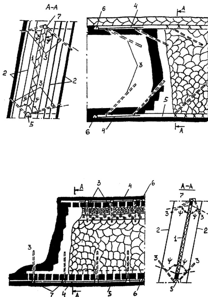
Рис.3.3.4 Схема дегазации крутых сближенных пластов скважинами, пробуренными из выработок разрабатываемого пласта:
