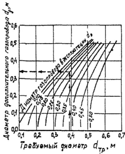
Рис. П6.3.5 Нограмма для определения диаметра дополнительного газопровода
