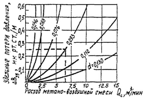
Рис. П6.3.2 Номограмма для определения удельных потерь давления в скважине
