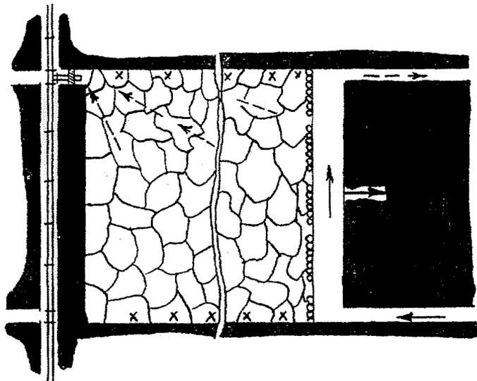
Рис.4.2.4 Отсос газа из выработанного пространства выемочного участка на фланговую выработку
