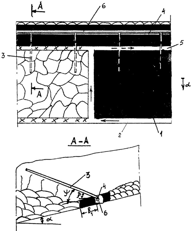
1-разрабатываемый пласт; 2-конвейерный штрек; 3-дегазационная скважина; 4-дегазационный трубопровод; 5-вентиляционный штрек; 6-выработка, охраняемая целиком углем;  $\alpha$  - угол падения пласта;  $\psi$ -угол разгрузки пород кровли;  $\beta$  - угол вскрывания скважины
