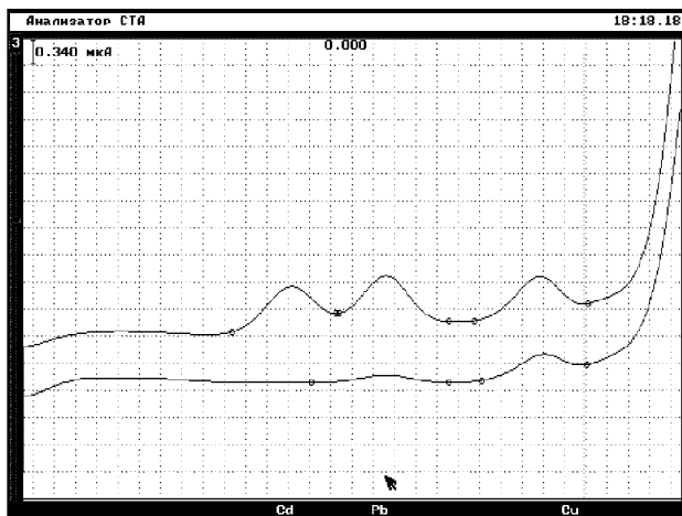
Рисунок 2. Вольтамперограммы кадмия, свинца и меди (при раздельном определении) в растворе пробы (1) и пробы с добавками АС элементов (2)
