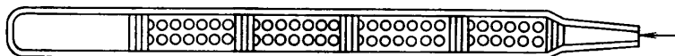
Рис. 1.7. Сорбционная трубка с силикагелем для отбора из воздуха анилина, нитробензола и ароматических углеводородов
