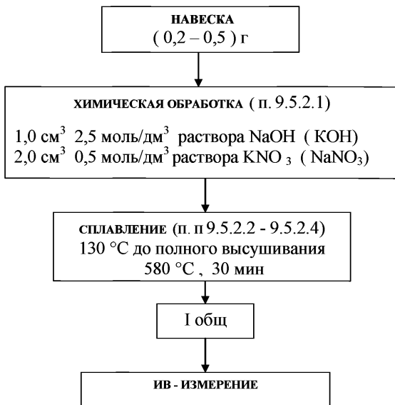
Рисунок. 2 Схема пробоподготовки для определения общего содержания йода, в кормах и кормовых добавках методом ИВ
