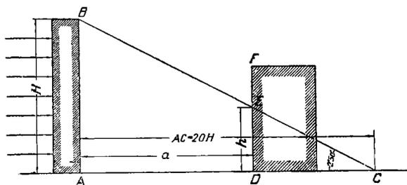
Если часть сооружения (EF) возвышается над границей BC ветровой тени, то ветровая нагрузка прикладывается только к этой возвышающейся части.
