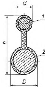
1 – трос; 2 – сердечник кабеля;  $d$  – диаметр изолированного троса;
