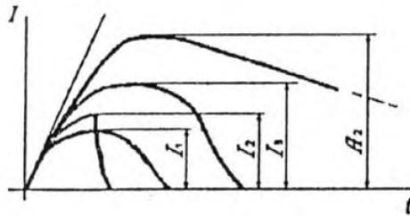
$I_1$  – первая калибровка;  $I_2$  – фактический ток отключения;  $I_3$  – вторая калибровка;
