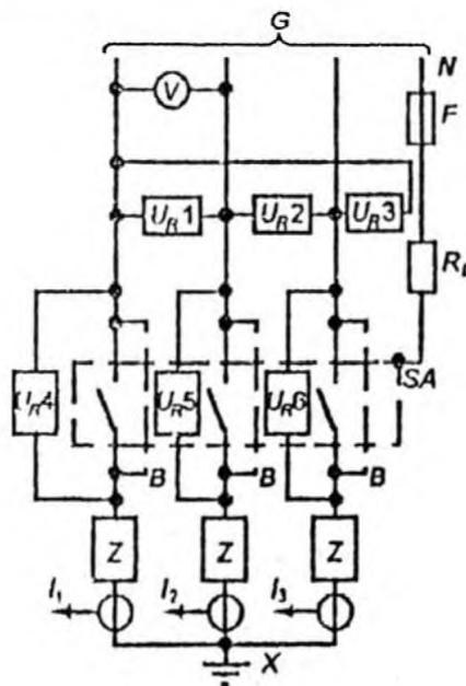
$B$  – временные калибровочные соединения;  $SA$  – испытуемый аппарат (с соединительными кабелями);
