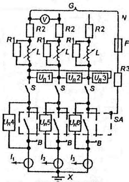
$S$  – замыкающее устройство;  $B$  – временные калибровочные соединения;
