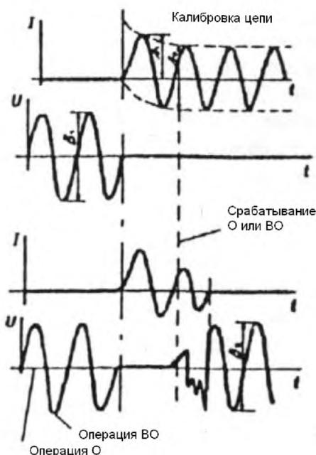
$A_1$  – ожидаемый пиковый ток включения;  $\frac{A_2}{2\sqrt{2}}$  – ожидаемый симметричный ток отключения (действующее значение);  $\frac{A_2}{2\sqrt{2}}$  – отключающая способность (действующее значение);  $\frac{B_1}{2\sqrt{2}}$  – напряжение до включения (действующее значение);  $\frac{B_2}{2\sqrt{2}}$  – сетевое (питающее) напряжение (действующее значение).
