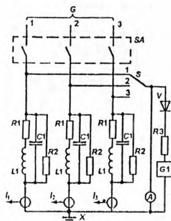
$A$  – осциллограф;  $V$  – диод;  $S$  – селекторный переключатель для регулировки фазы;
