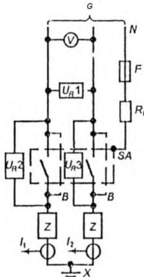
*B* – временные калибровочные соединения; *SA* – испытуемый аппарат (с соединительными кабелями);
