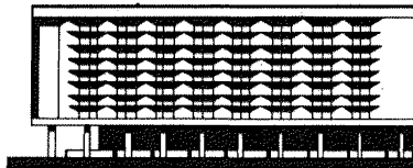
Рис.67. Примеры использования солнцезащитных устройств в архитектурной композиции зданий. Комбинированный тип. Швейная фабрика в Ташкенте a – фрагмент фасада здания; b – общий вид со стороны магистрали
