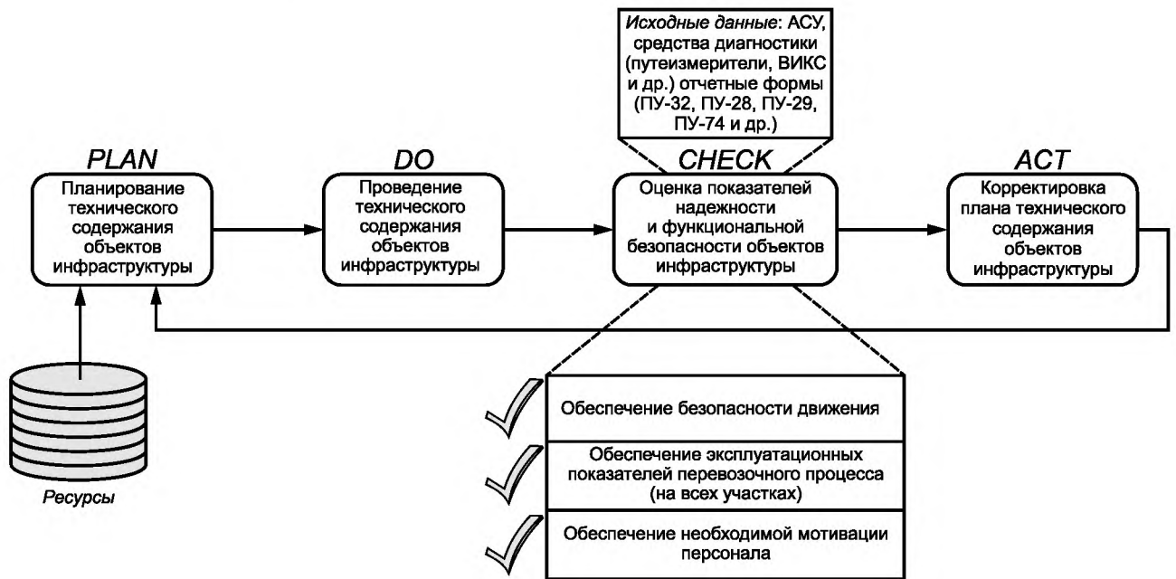
Рисунок А.1 — Применение модели PDCA при управлении техническим содержанием объектов инфраструктуры железнодорожного транспорта
