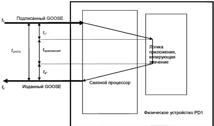
Рисунок 8. Измерение времени приема-передачи с использованием «пинг-понг» метода для GOOSE-сообщений
