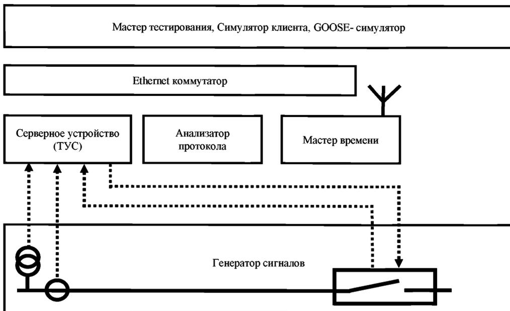
Рисунок 3. Архитектура испытательной системы для проверки серверного устройства
