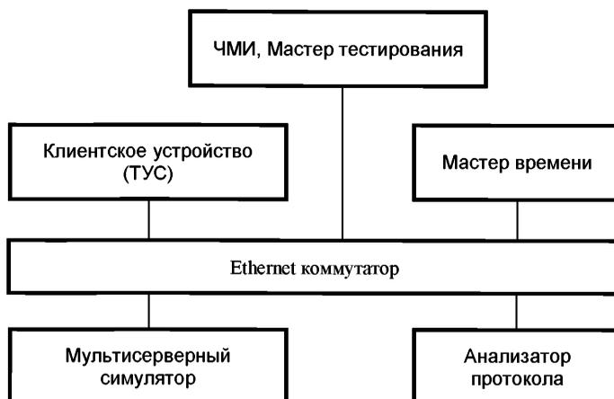
Рисунок 4. Архитектура испытательной системы для проверки клиентского устройства
