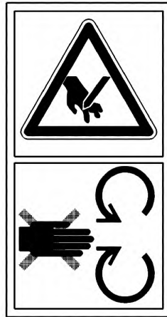
Рисунок С.1 – Опасности, связанные с движущимися частями
