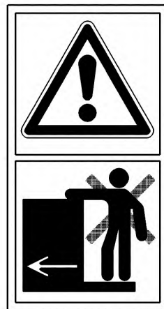
Рисунок С.2 – Опасность подъема на движущуюся машину
