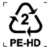
**В.2-суреті — Тығыздылығы жоғары полиэтилен (PE-HD)**
