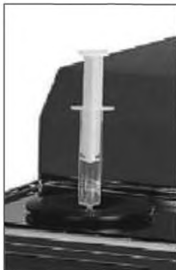
Рисунок 1 – Шприц, введенный во впускное отверстие
