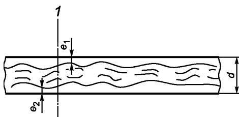
$d$  — общая толщина;  $e_1$  — толщина верхней обкладки;  $e_2$  — толщина нижней обкладки;
