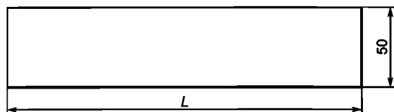
Рисунок 1 — Образец для испытаний типа 1 (прямоугольный)
