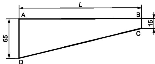
Рисунок 2 — Образец для испытаний типа 2 (клиновидный)
