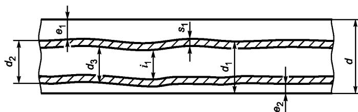
$d$  — общая толщина;  $d_1$  — толщина образца без верхней обкладки;  $d_2$  — толщина образца без верхней и нижней обкладок;  $d_3$  — толщина образца без одного текстильного слоя<sup>a)</sup>;  $e_1$  — толщина верхней обкладки;  $e_2$  — толщина нижней обкладки;  $i_1$  — толщина промежуточного слоя<sup>a)</sup>;  $s_1$  — толщина текстильного слоя<sup>a)</sup>
