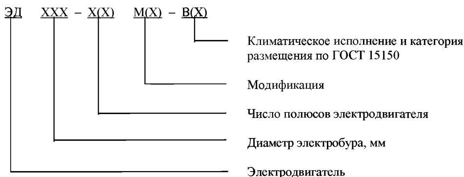
*Пример условного обозначения типа электродвигателя для электробура диаметром 164 мм, числом полюсов 4, первой модификации, климатического исполнения В, категории размещения 5:*
