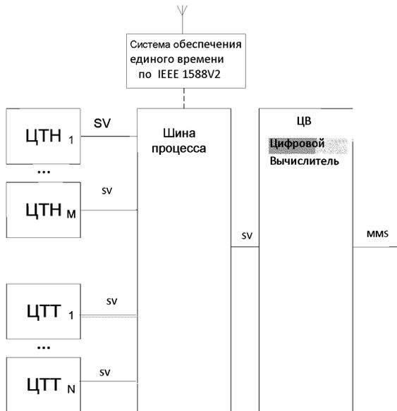
Рис. 1. ИК для измерения электрических параметров присоединений 110 - 750 кВ
