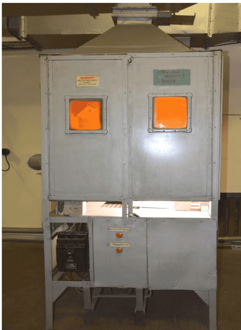
Рисунок Г.2 – Установка для ультрафиолетового облучения
