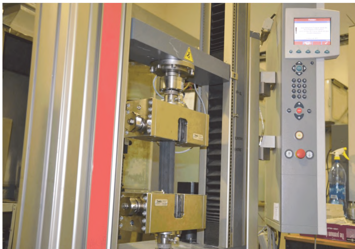
Рисунок Г.4 – Универсальная испытательная машина серии Zwick/Roell Z005
