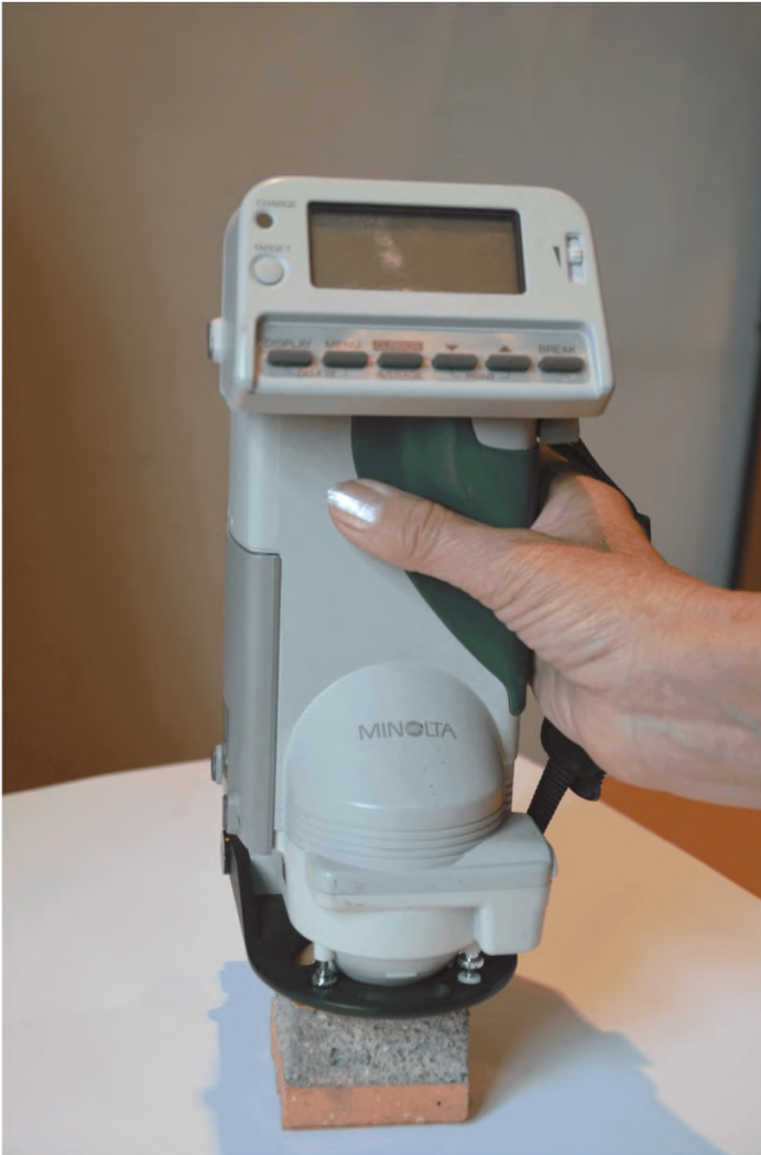
Рисунок Г.8 – Замер координат цвета на поверхности образца штукатурной краски с помощью цветоизмерительного спектрофотометра
