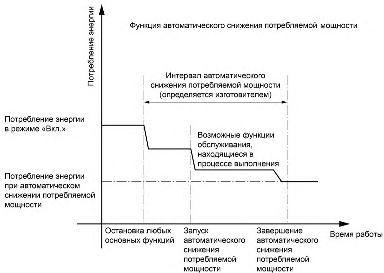
Рисунок 1 — Функция автоматического снижения потребляемой мощности
