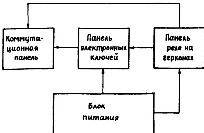
Рис. 2.5. Блок-схема прибора для изменения параметров решаемой задачи.
