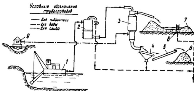
Рис.6. Схема цепи аппаратов по переработке песка в напорном потоке:
