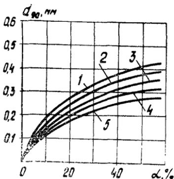
Рис. II. Зависимость размера частиц грунта в сливе, соответствующего 90 % на кривой грансостава, от относительного расхода слива ( $\alpha$ ): 1-5 - для исходного материала при  $\lambda_{0,315}$ , составляющем соответственно 10, 30, 50, 70 и 90%.
