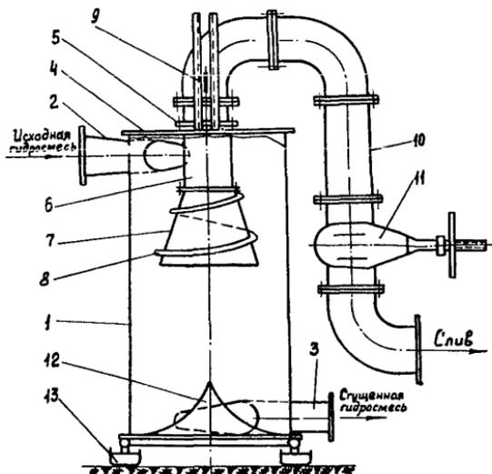
Рис.1. Схема сгустительно-обогажительного аппарата типа ГЦТ:
