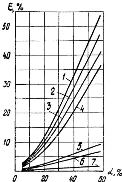
Рис.10. Зависимость извлечения твердого материала в слив по фракциям от относительного расхода слива: 1, 2, 3 и 4 - извлечение фракции менее 0,14 мм для исходного материала при  $\lambda_{0,315}$  равном соответственно 10, 35, 60 и 85%; 5 и 6 - извлечение фракции 0,14 - 0,315 мм для исходного материала при  $\lambda_{0,315}$ , равном соответственно 10 и 85%; 7 - извлечение фракции 0,315-0,63 мм.
