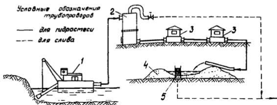
Рис. 4. Схема подключения аппарата ГЦТ в гидротранспортную систему с перекачивающими станциями:
