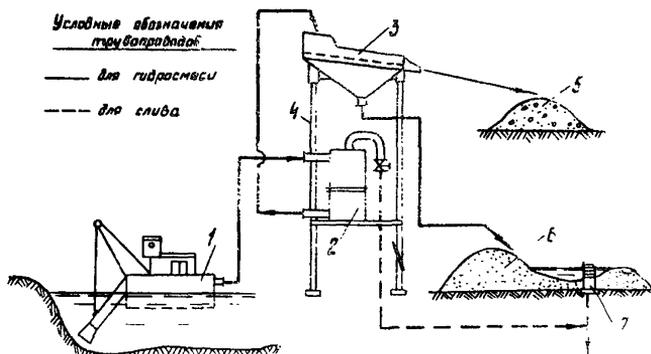
Рис. 9. Схема цепи аппаратов с использованием гидроциклона типа ГЦТ в комплексе с виброгрохотом
