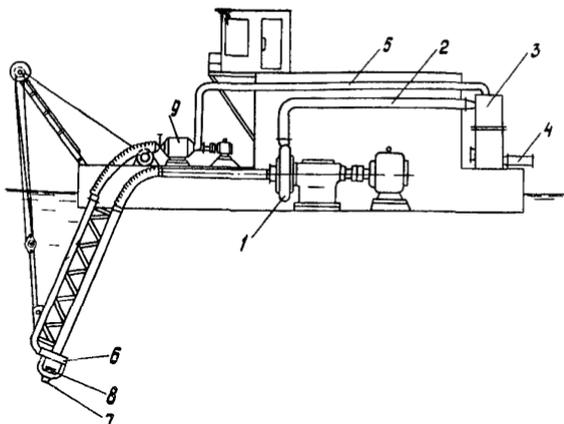
При работе земснаряда на участках, засоренных легкими растительными включениями, которые в процессе работы могут попасть в сливной трубопровод, в линию последнего включают специальное корнерезное устройство 9, предназначенное для измельчения этих включений и предотвращения тем самым закупорки гидравлических насадков.
