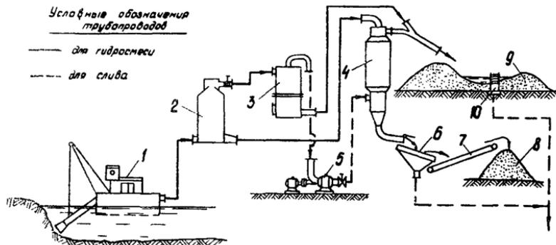
Рис.8. Схема цепи аппаратов с использованием гидроциклона типа ГЦТ в комплексе с аппаратом ОГВ:
