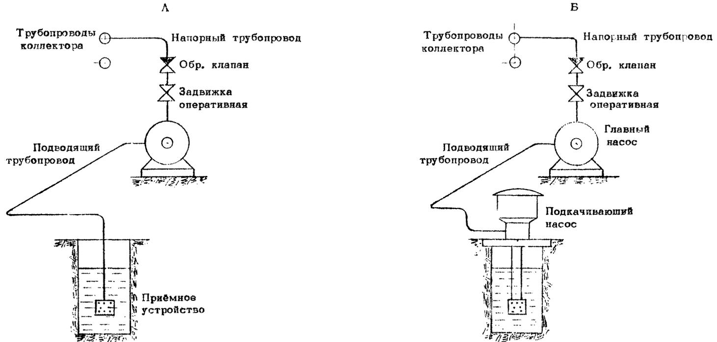
Рис. 6. Гидравлические схемы насосных агрегатов.
