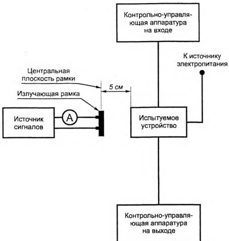
Рисунок А.3 – Типовая схема испытаний для неоднородного магнитного поля в полосе частот 50 Гц – 10 кГц
