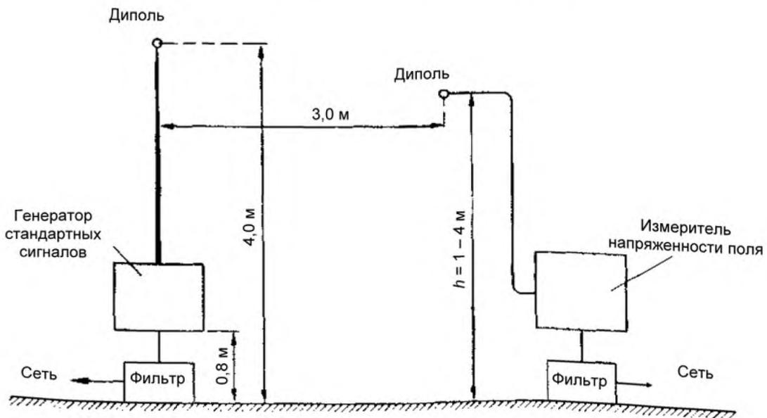
Рисунок 12 – Проверка соответствия измерительной площадки (см. 5.7.2)
