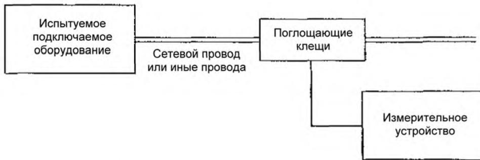
Рисунок 10 – Схема для измерения мощности помех от подключаемого оборудования (за исключением видеоманитонов) (см. 5.6.3)
