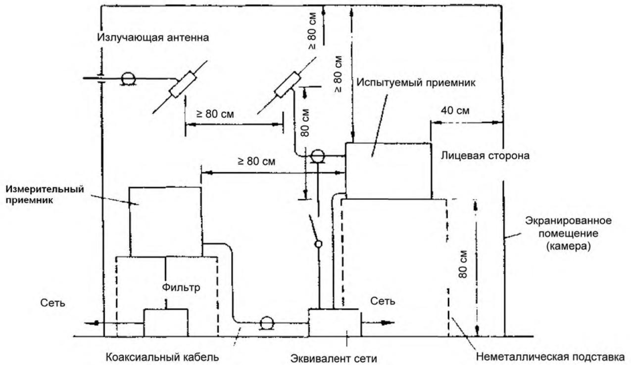
Рисунок 5 – Измерение напряжения радиопомех на сетевых зажимах (см. 5.3.1)
