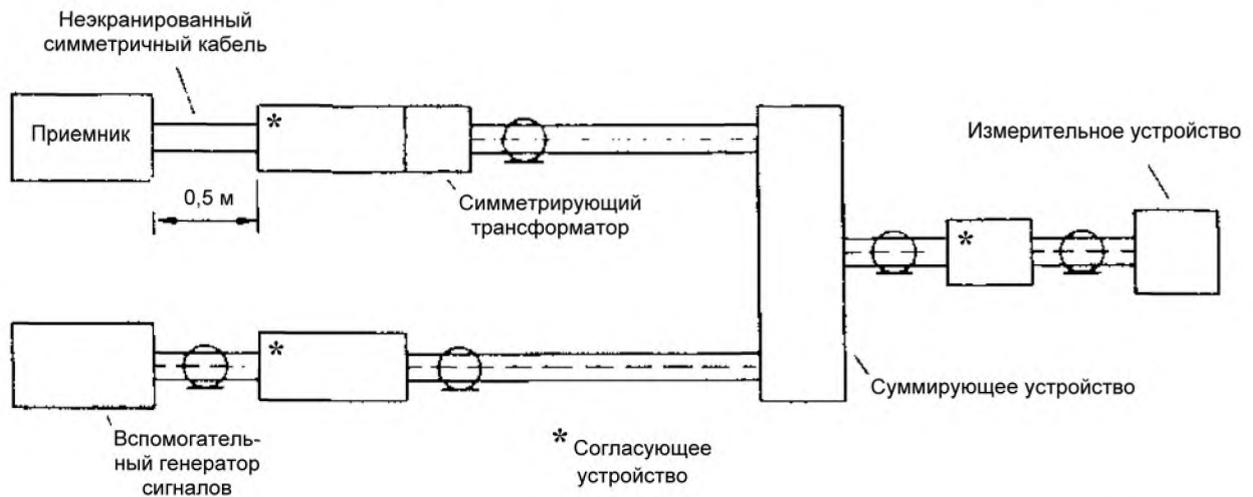
Примечание – Симметрирующее устройство может включать устройство для подавления любых асимметрирующих токов.
