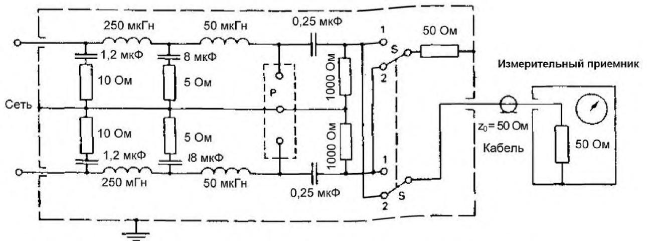
P – соединение для подключения испытываемого оборудования
