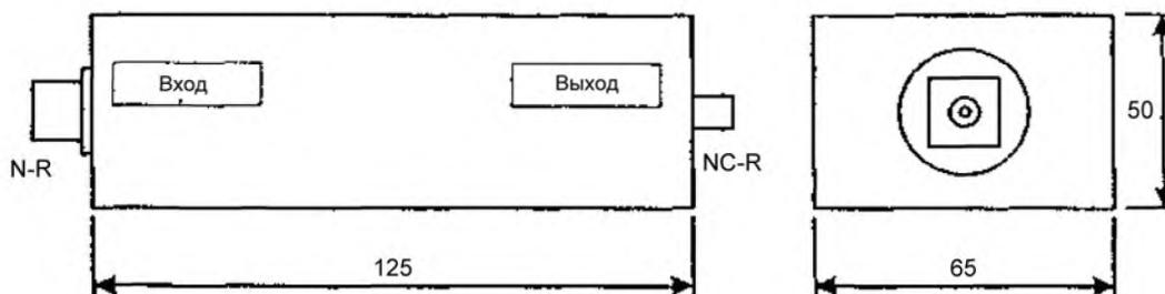
Рисунок А.3 – Типовые размеры изолирующего трансформатора для диапазона частот от 46 МГц до 1,5 ГГц
