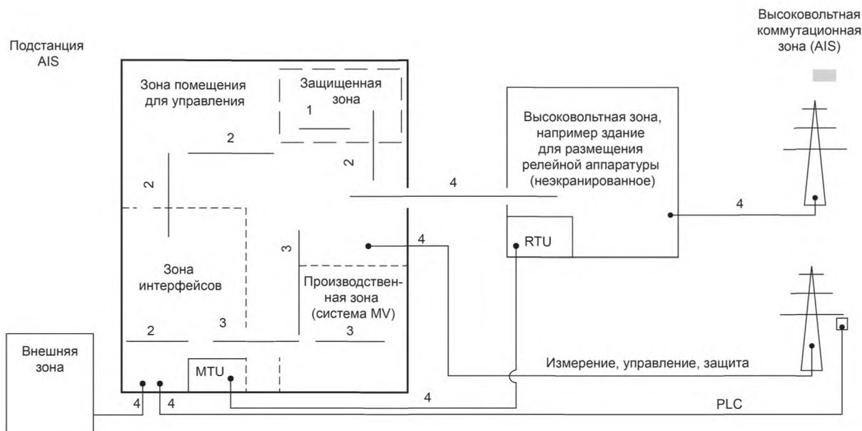
MTU — основное оконечное устройство; RTU — удаленное оконечное устройство;
