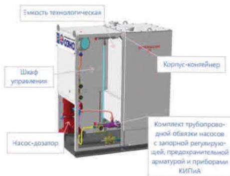
Рисунок 2.24 – Оборудование блока дозирования реагентов
