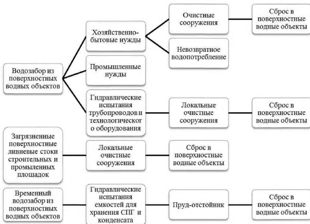
Рисунок 3.5 – Организация временного водоснабжения и пути отвода сточных вод на этапе строительства [58]
