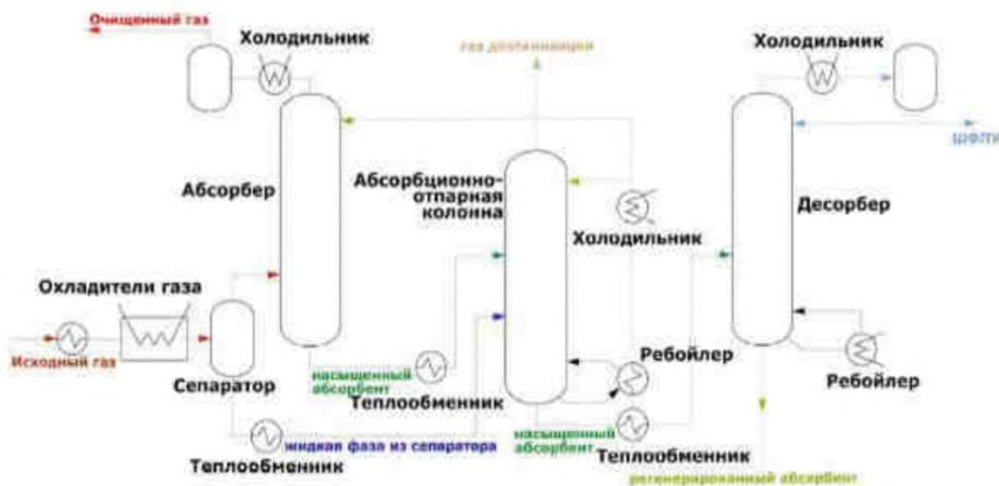
Рисунок 2.20 – Типовая схема установки масляной абсорбции
