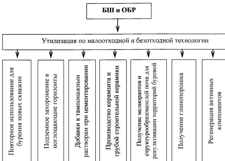
Рисунок 2.39 – Основные направления утилизации отходов бурения
