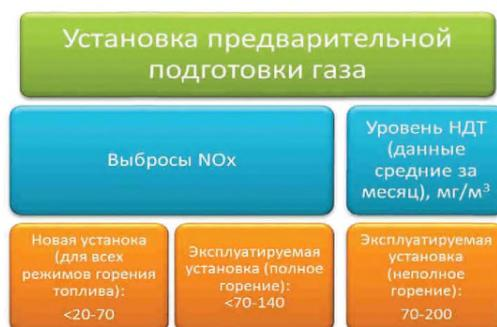
Рисунок 3.8 – Уровни НДТ для установок предварительной подготовки газа
