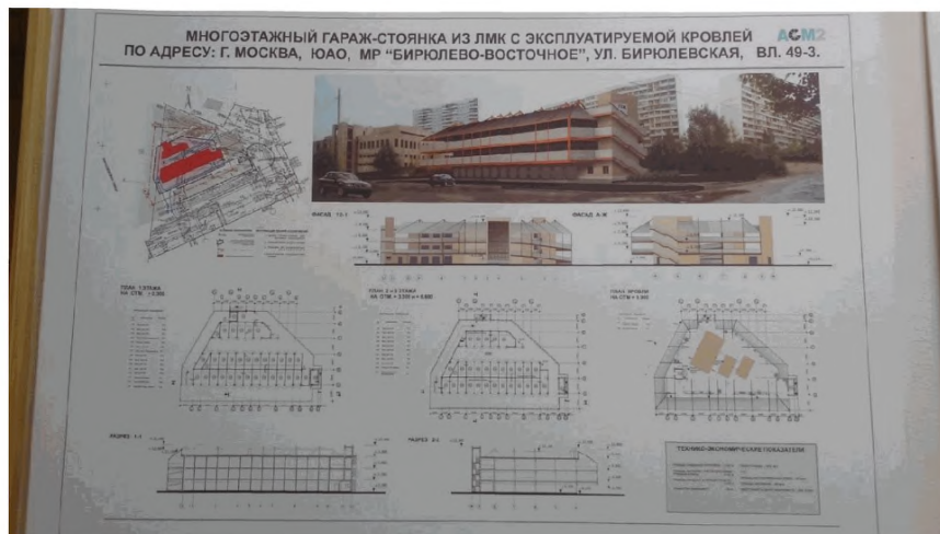
Рисунок 23 – Здание стоянки с размещением на двух этажах машин в боксах, имеющих выезды наружу на открытые пандусы
