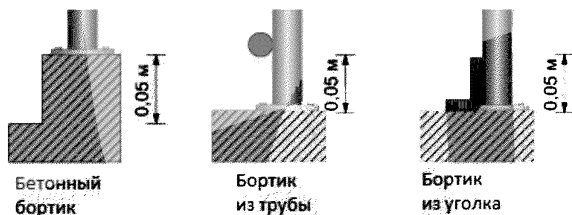
Рисунок 6.1.27 – Конструкция бортика на пандусе
