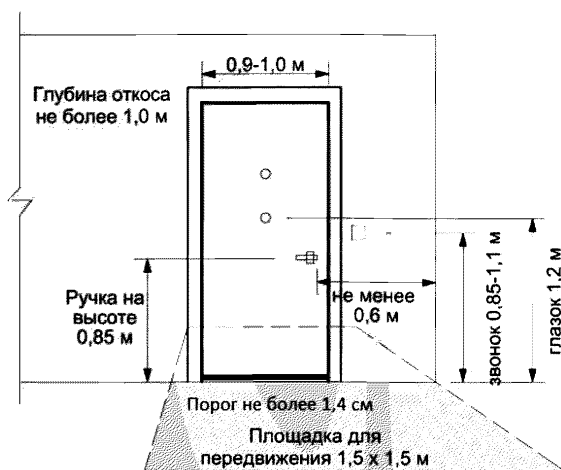
Рисунок 6.5.3 – Приспособление входа в квартиру для инвалида на кресле-коляске
