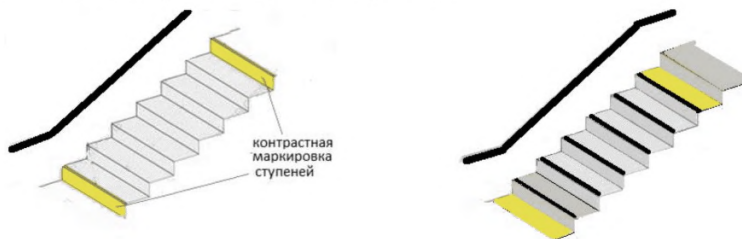
Рисунок 6.6.4 – Ошибки при контрастной маркировке ступеней
