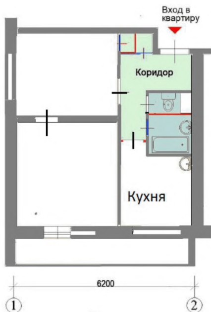
Рисунок 6.5.20 – Перепланировка в блочном доме с расширением санузла
