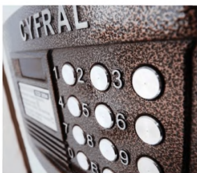
Рисунок 6.6.11 – Домофоны с тактильными контрастными цифрами
