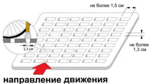
Рисунок 6.1.30 – Размер ячеек водосборных решеток
