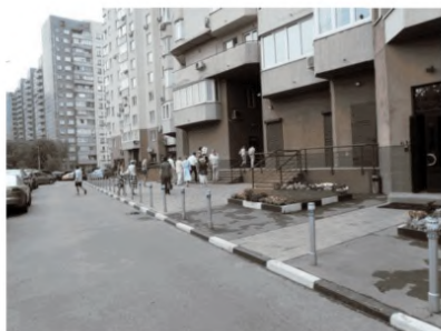
Разделение тротуара и проезжей части дорожным бордюром и столбиками
