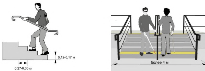
Рис.6.1.10, а – Ступени единой геометрии и поручни на широких лестницах
