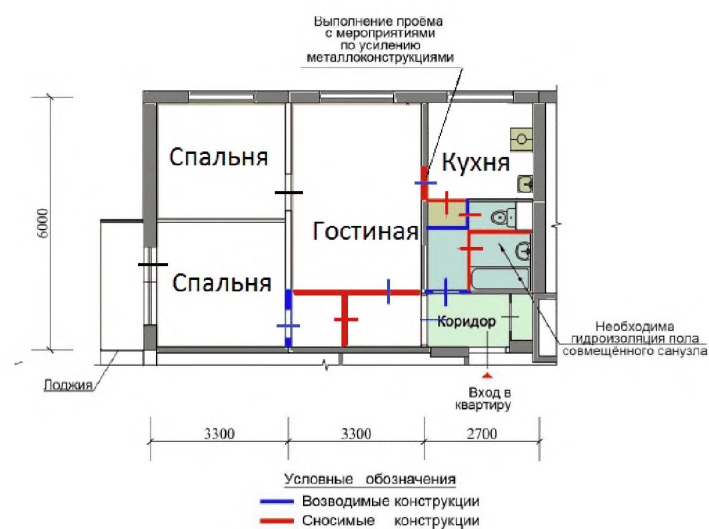
Рисунок 6.5.18 – Варианты перепланировки в панельном доме с увеличением площади санузла и выполнением проема в несущей стене из гостиной на кухню с усилением металлоконструкциями
