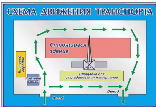
Рисунок 11 – Схема организации движения на стройплощадке
