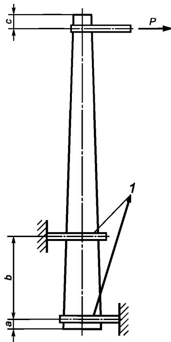
*a* — расстояние от торца секции до первого стропа; *b* — расстояние между удерживающими стропами; *c* — расстояние от торца секции до крепления тянущего троса (стропа); *P* — изгибающая сила; 1 — строп
