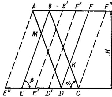
Рис. 9. Отработка пласта со стороны лежащего бока
