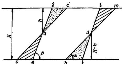
Рис. 8. Оработка пласта при частичном засорении добычи породой
