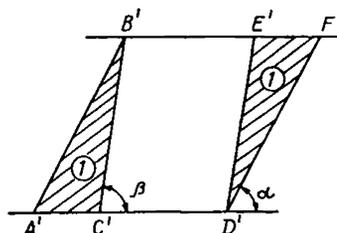
Рис. 7. Отработка пласта с максимальными потерями (1) угля
