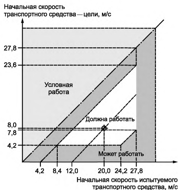
Рисунок 9 — Испытание функциональных возможностей и скорости движения испытываемого транспортного средства и транспортного средства — цели
