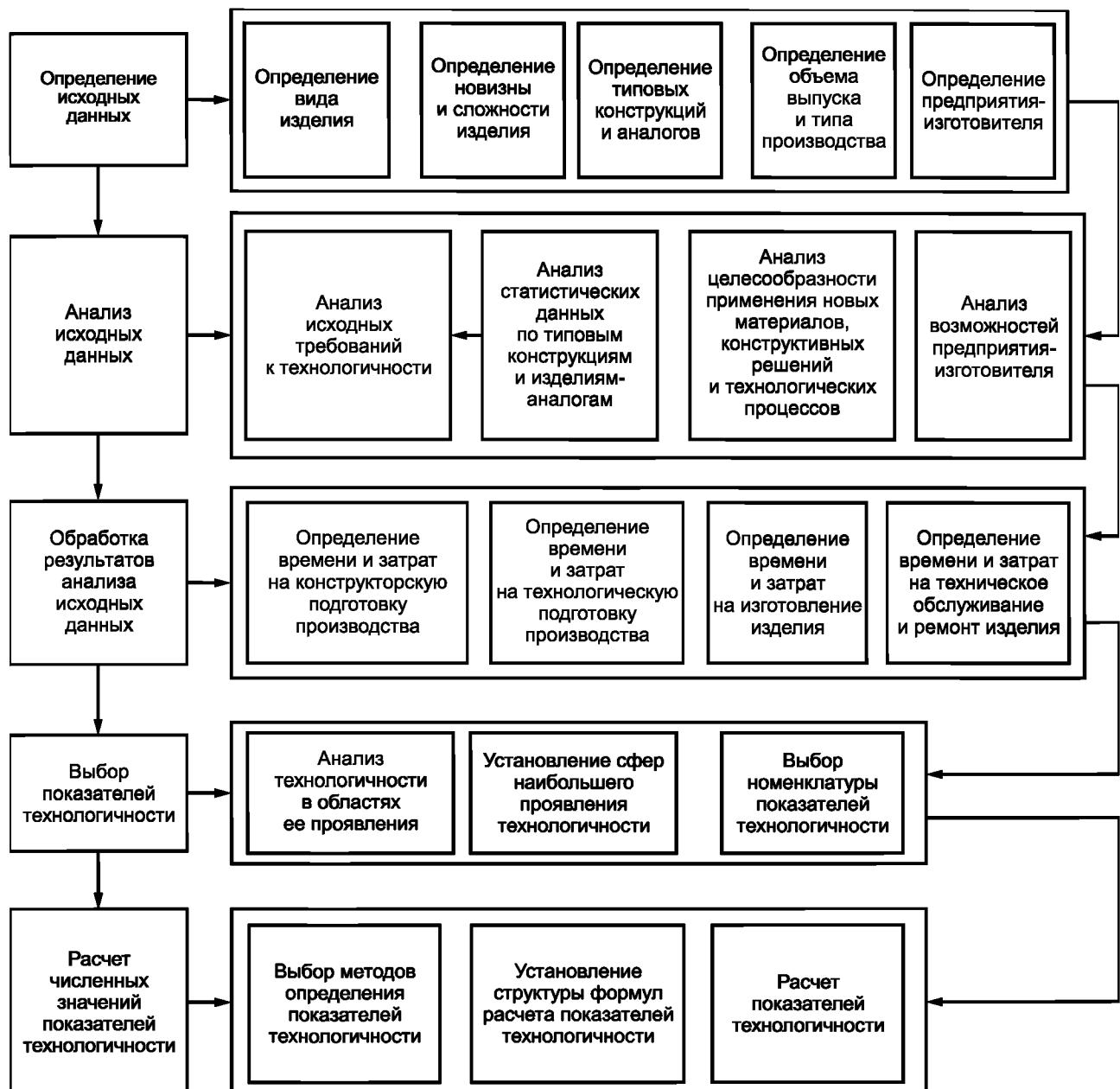
Рисунок 1 — Блок-схема определения показателей технологичности
