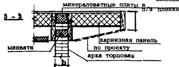
Рис. 24. ШАТРОВЫЙ КУПОЛ. РАСКЛАДКА ПАНЕЛЕЙ ПРИ ШЕСТИУГОЛЬНОМ ПЛАНЕ Рис. 25. ШАТРОВЫЙ КУПОЛ. СЕЧЕНИЯ ПО ПОКРЫТИЮ
