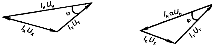
Рисунок К.2 — Векторные диаграммы для мощности на соответствующих выводах и в существующих обмотках
