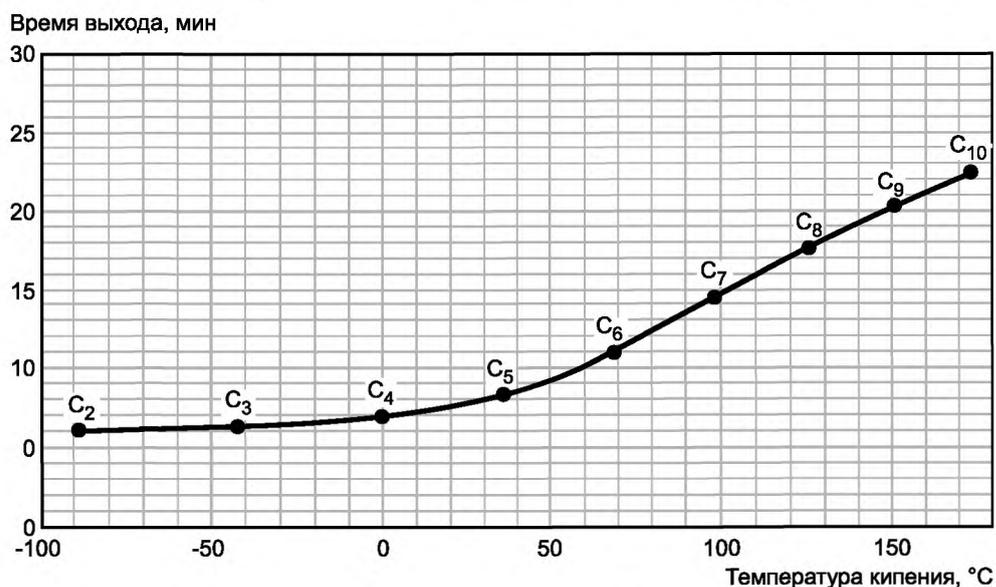
Рисунок Д.1 — Пример графика зависимости времени выхода *n*-алканов C<sub>2</sub>—C<sub>10</sub> градуировочной смеси от их температур кипения
