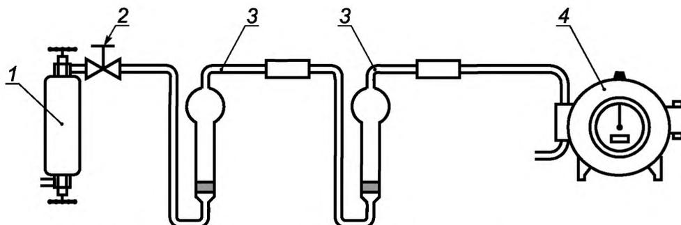
1 — баллон-пробоотборник; 2 — вентиль тонкой регулировки расхода газа;
