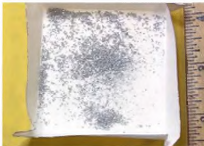
Рисунок 13 – Материал шариков припоя, собранный из корпуса BGA посредством процедуры удаления вручную
