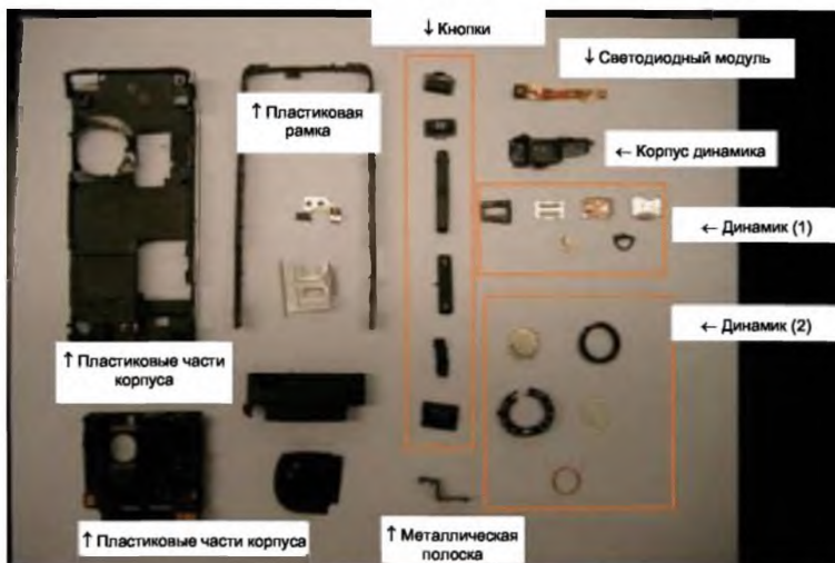
Рисунок 6 – Полная разборка нижней части корпуса
