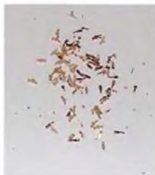
Рисунок 10b – Металлические выводы после разделения
