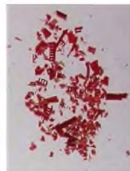
Рисунок 10с – Корпус ИМС после разделения
