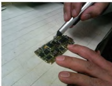
Рисунок D.2 – Вакуумный пинцет для извлечения требуемых электронных устройств
