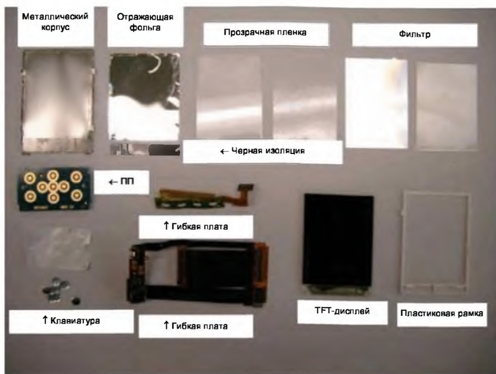
Рисунок 8 – Компоненты TFT-дисплея сотового телефона после частичного разделения
