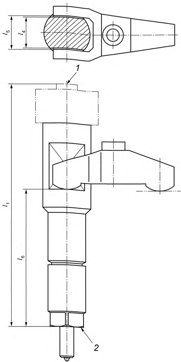
1 — верхняя часть форсунки; 2 — поверхность уплотнения форсунки
