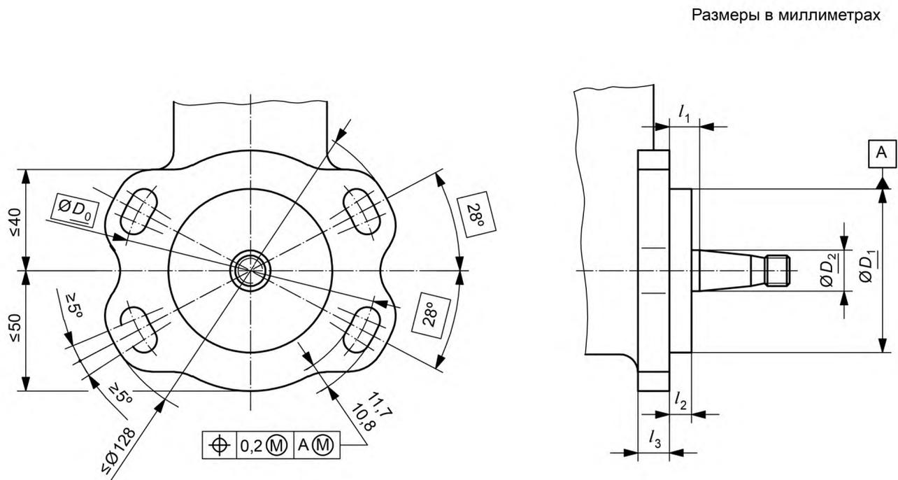
Рисунок 7 — Монтажный фланец типа 7
