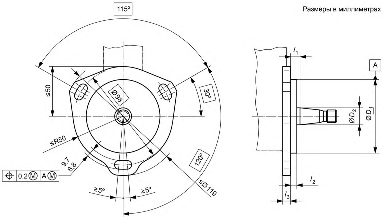
Рисунок 5 — Монтажный фланец типа 5
