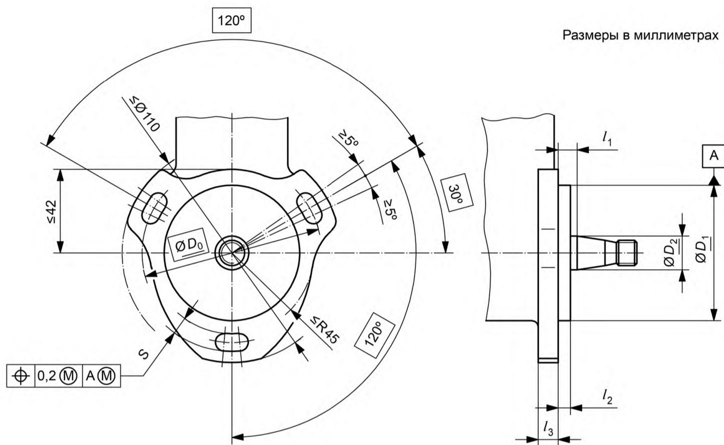
Рисунок 4 — Монтажный фланец типа 4
