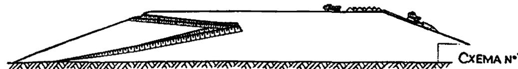
СХЕМА ПОНИЖЕНИЯ ОТВАЛА ПОГРУЗЧИКОМ С ВЫВОЗКОЙ ПОРОДЫ АВТОТРАНСПОРТОМ.
