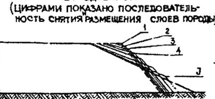
ТЕХНОЛОГИЯ РАЗБОРКИ ВТОРОГО ЯРУСА ОТВАЛА
