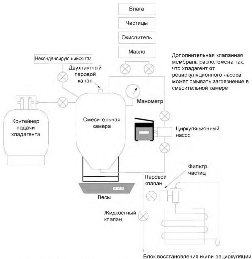
**Рисунок АА.1 – Испытательная аппаратура для автономного оборудования**
