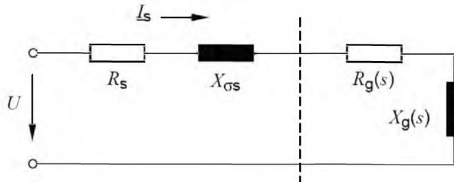
Рисунок 9 – Асинхронные машины, упрощенная эквивалентная схема для расчета
