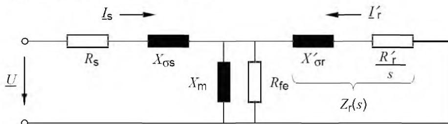
Рисунок 5 – Асинхронная машина, Т-образная эквивалентная схема замещения с резистором, учитывающим потери в стали
