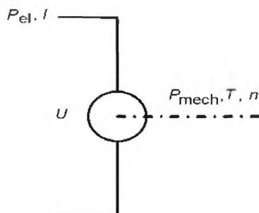
Рисунок 1 – Схема испытания для измерения вращающего момента
