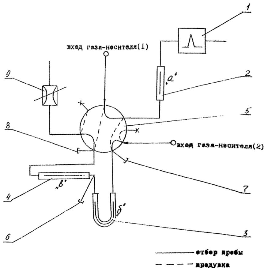
Рис.1 Схема соединения колонок.
